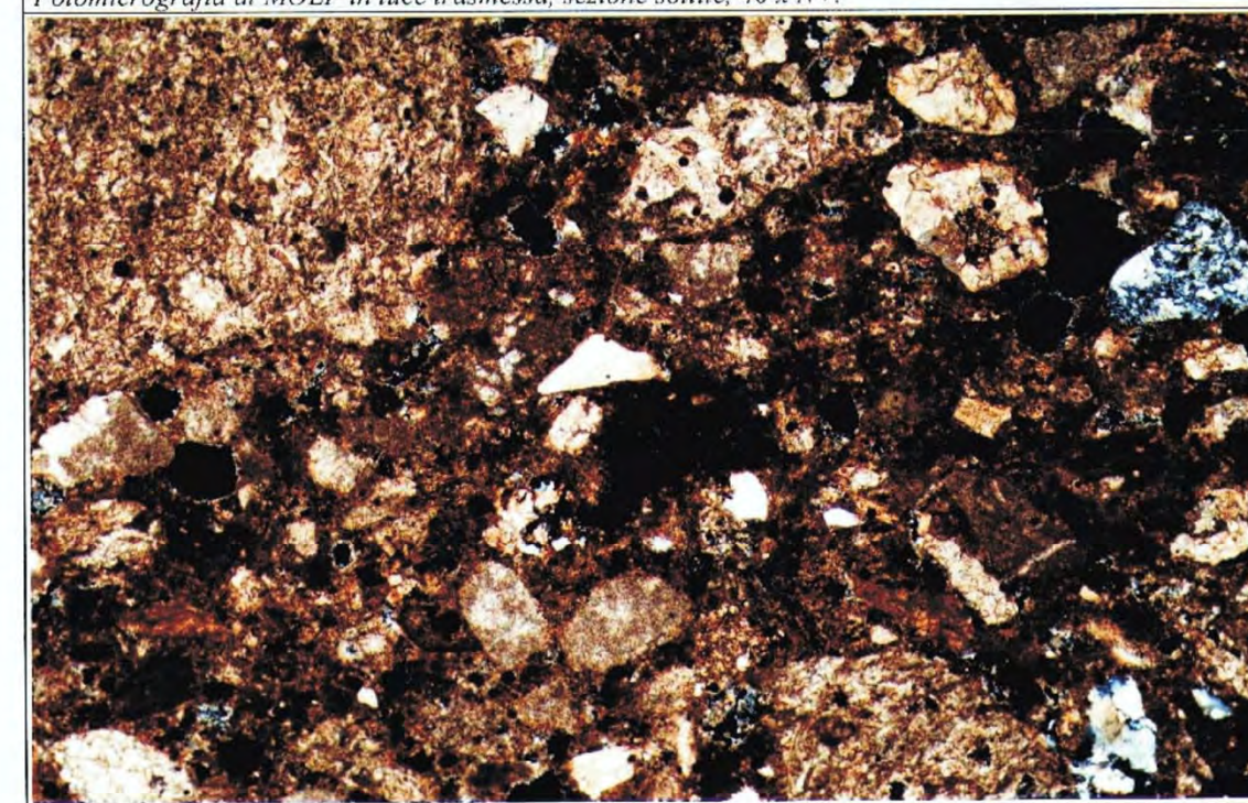
Campione 5 (impasto inferiore). La carica inerte ha granulometrie sia medio – fini che grossolane. Fotomicrografia al MOLP in luce trasmessa, sezione sottile, 40 x N+.
