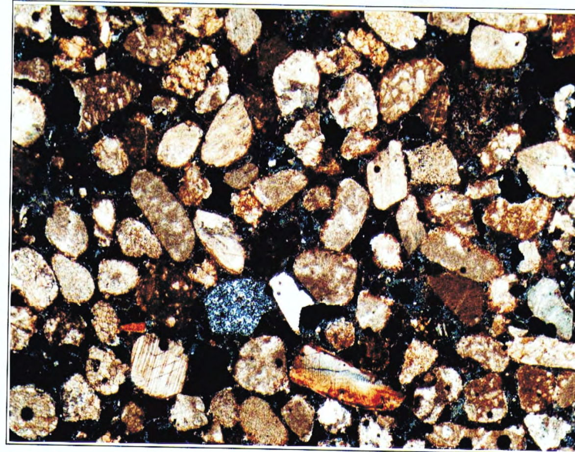
Campione 3. Nell'immagine si può verificare la composizione prevalentemente carbonatica della sabbia. Il frammento bianco e nero rappresenta della selce. Fotomicrografia al MOLP in luce trasmessa, sezione sottile, 40 x N+.
