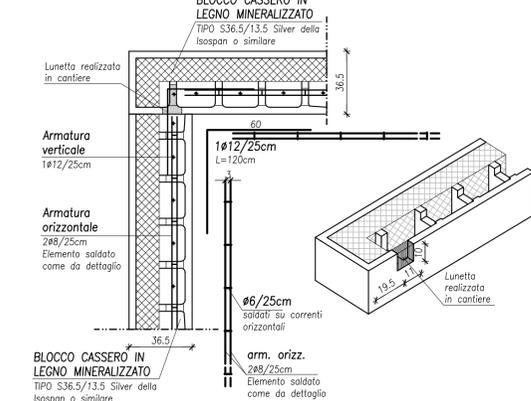
**ARMATURA MURO DI SOSTEGNO 1**
