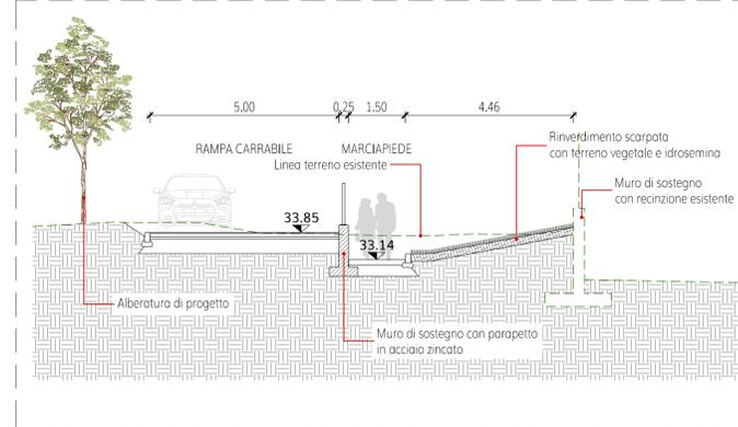
**Particolare costruttivo muro di sostegno**
