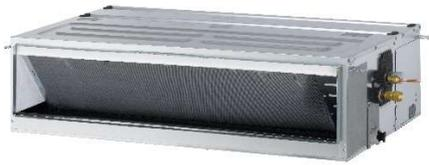
Anche le unità interne canalizzabili vengono posizionate in controsoffitto, sorrette da strutture di sostegno in profilati zincati a C tipo 41x41
