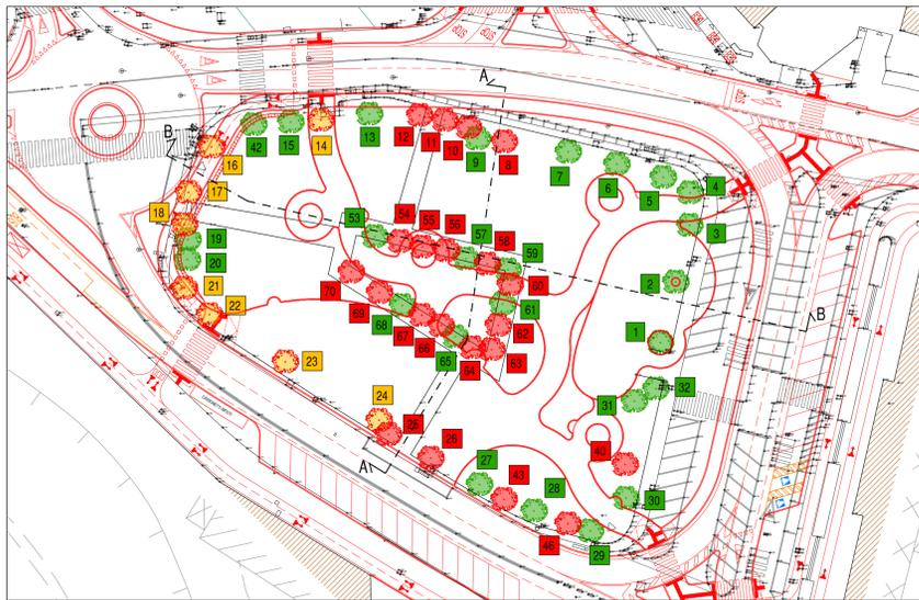
Piazzale De Gasperi - Planimetria di progetto sovrapposta al rilievo topografico con indicazione delle alberature esistenti - scala 1:500 (rif. Tabella, fonte: Amministrazione comunale)
